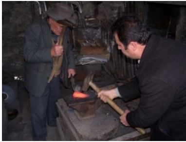
Fotoğraf 24: Demirin Örs Üzerinde Dövülmesi. Kaynak Abdullah BAKIR.
