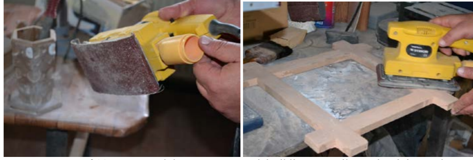
Fotoğraf 11: Kuruyan dolgu macununun elektrikli zımpara ile tesviyesinin yapılması.
